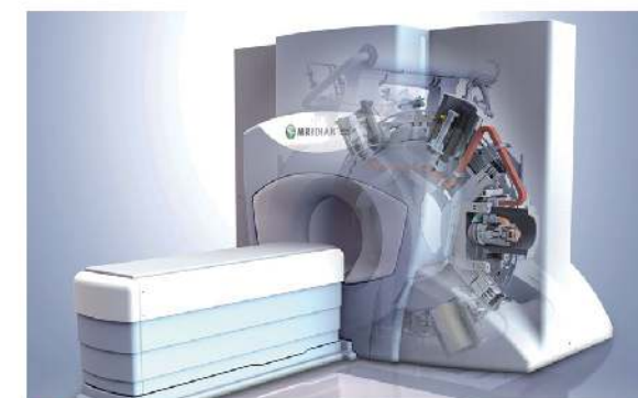
图一 磁共振导引直线加速器MRIdian-Linac透视图
